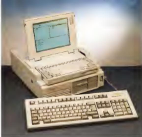
Il notebook montato sul box di espansione. Chiudendo l'arco del display è possibile appoggiare sul tutto un monitor esterno.
